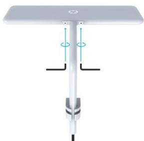
● Ajuste a altura e aperte os parafusos
